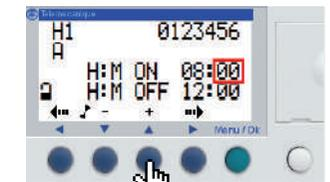
Appuyer sur ► pour accéder au champ des minutes de mise en route, et le modifier si besoin en appuyant sur ▲.
