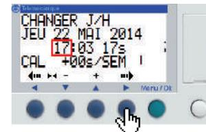
Appuyer sur **▶** pour sélectionner les heures. Appuyer sur **▲** ou **▼** si besoin pour modifier l'heure.
