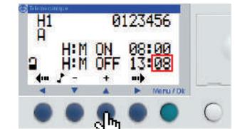
Appuyer sur ► pour accéder au champ des minutes d'arrêt, et le modifier si besoin en appuyant sur ▲. Le paramétrage de l'horloge est terminé, vous pouvez alors passer au paramétrage de l'intensité.
